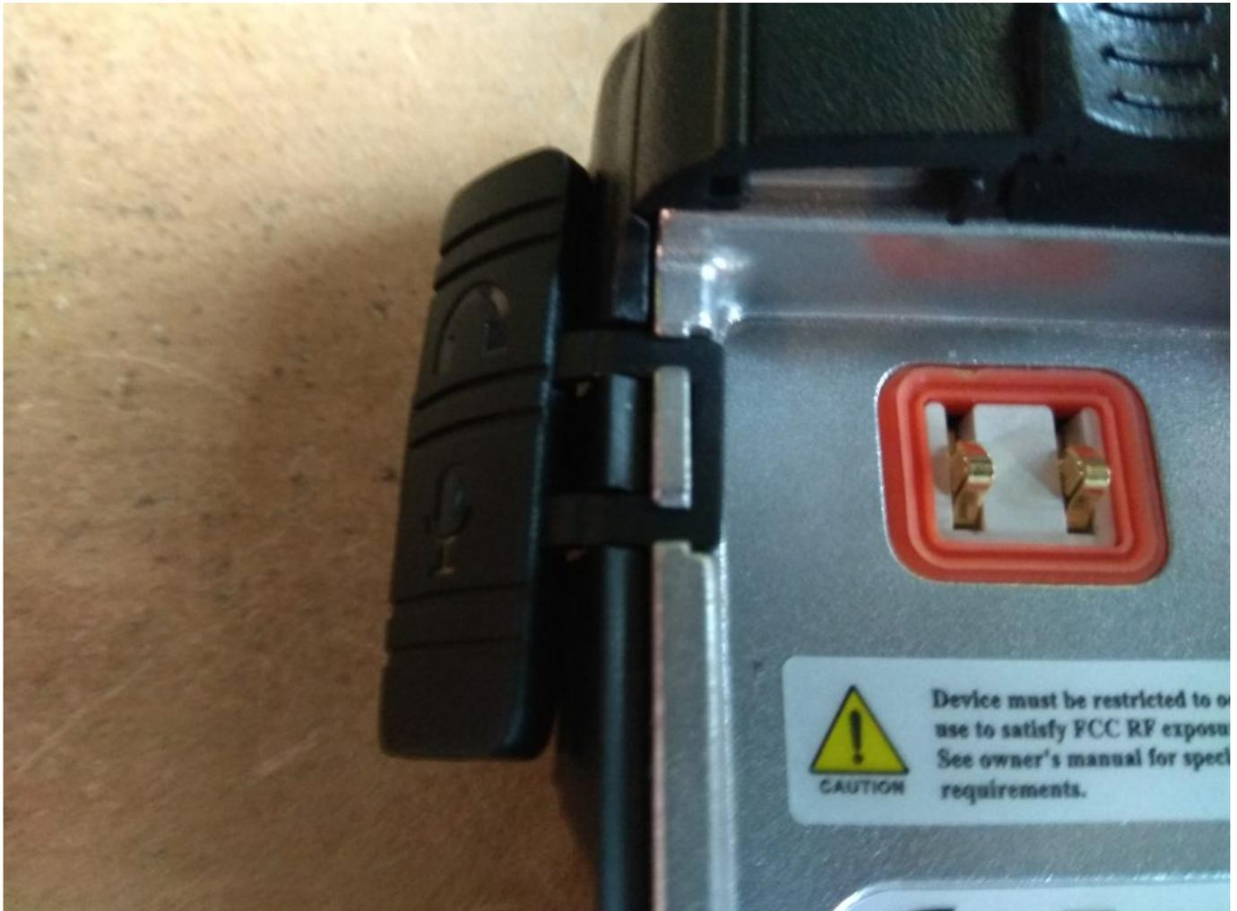
Jetzt hebeln wir ganz vorsichtig das Alu-Teil aus dem Gehäuse raus. Also zuerst unten hoch hebeln und dann nach hinten so raus ziehen das die Stifte der Potis aus dem Gehäuse raus kommen. Dabei aufpassen das man die beiden Flachbandkabel hinten nicht abreißt.
