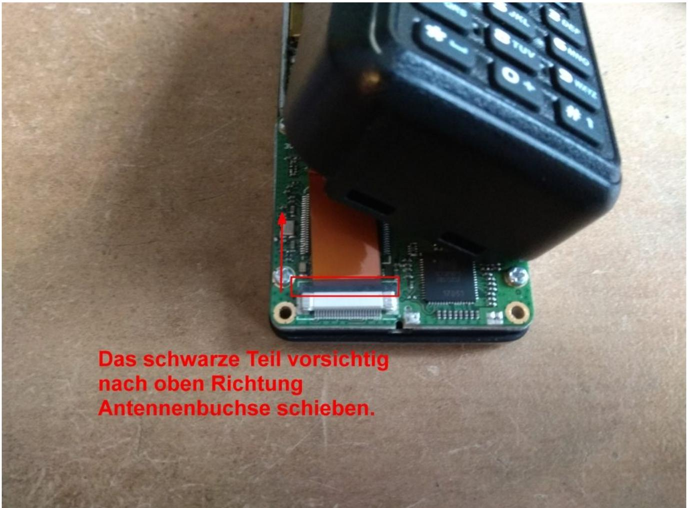
Hier kann man das Ganze nochmal sehen wenn das Kabel entfernt wurde. Oben im Bild ist der kleine Anschluss für das weiße Kabel zu sehen, dieses wird auf die selbe Art und Weise entfernt.
