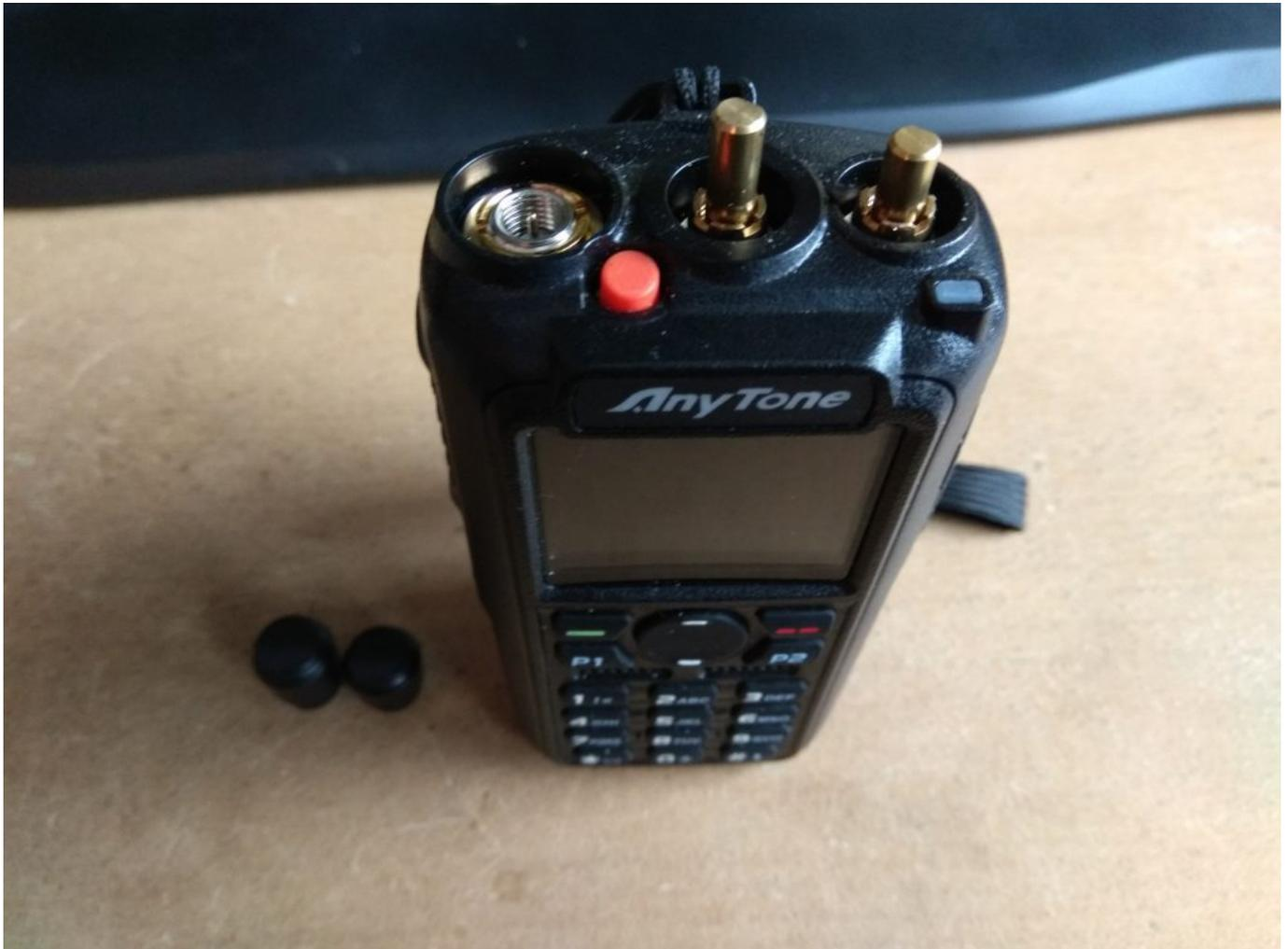
Als nächstes nehmen wir den Akku raus und lösen die beiden T8 (Torx 8) Schrauben die man unten (von hinten) sehen kann.
