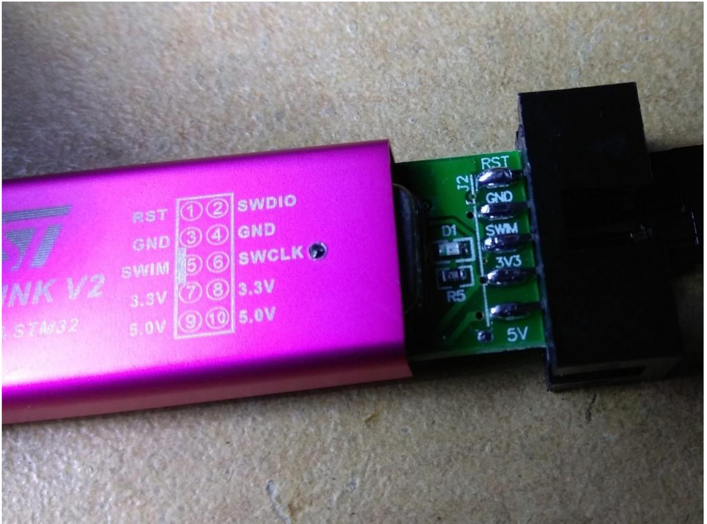
OK während die Verbindung auf der Seite vom Stick vermutlich noch extrem einfach ist in dem man einfach die Weiblichen Bread-Board-Leitungen verwendet so ist der Anschluss auf der Platine vom Anytone schon etwas nerviger.
